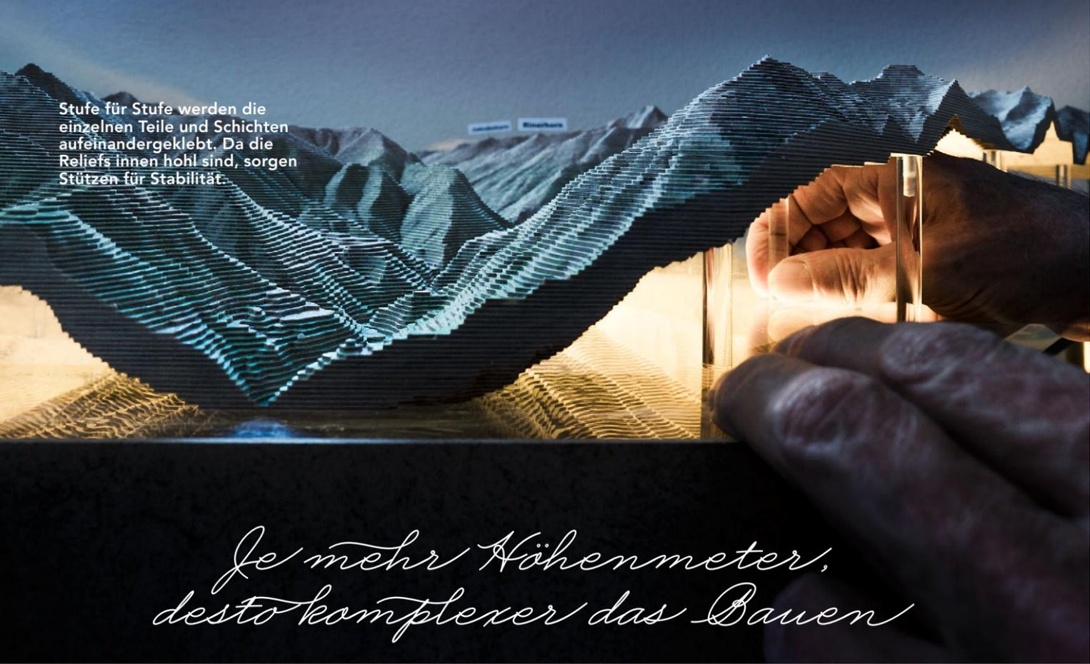
Stufe für Stufe werden die einzelnen Teile und Schichten aufeinandergeklebt. Da die Reliefs innen hohl sind, sorgen Stützen für Stabilität.
